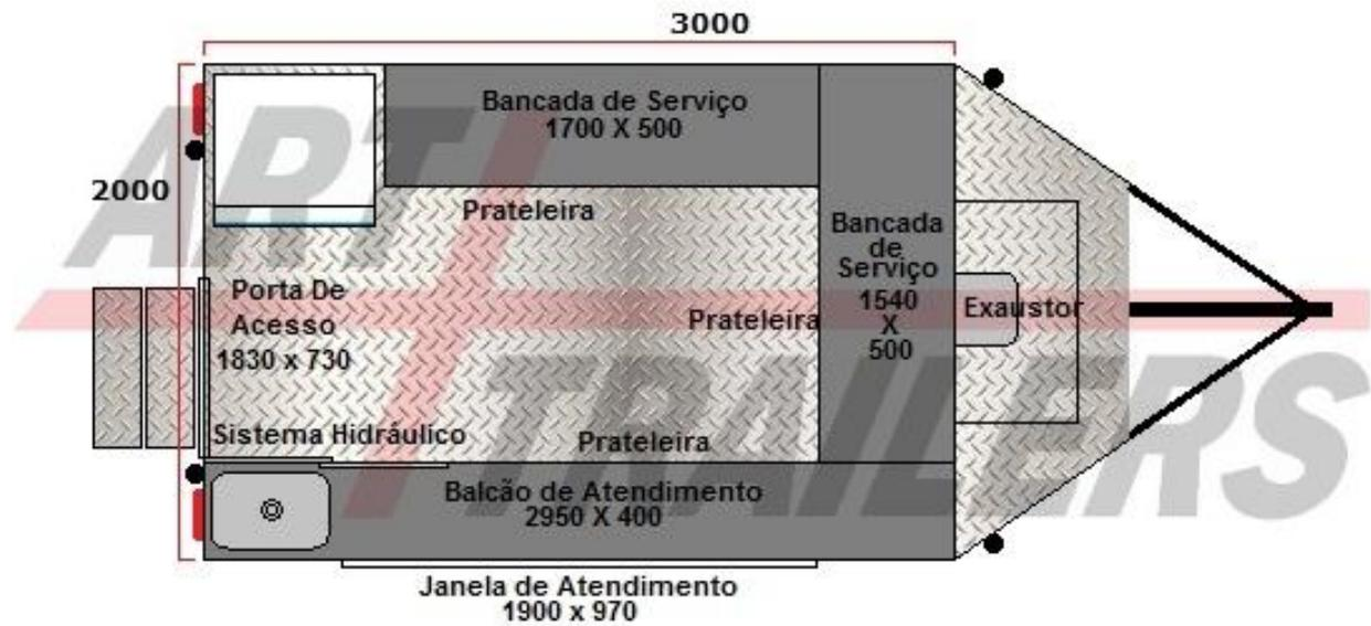
OBS: A PLANTA BAIXA APRESENTADA NESTE ORÇAMENTO É UM PROJETO DE DIMENSIONAMENTO DE BANCADAS E UMA SUGESTÃO DA DISPOSIÇÃO DOS EQUIPAMENTOS QUE SERÃO INSTALADOS DENTRO DO TRAILER, PODENDO SER ALTERADA PARA ATENDER A NECESSIDADE DO CLIENTE, DESDE QUE RESPEITE O PROJETO INICIAL ORIENTADO PELO ENGENHEIRO TÉCNICO RESPONSÁVEL.
